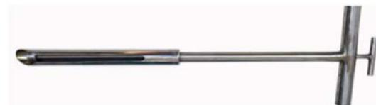
用土钻在被测点钻孔 35cm 深的洞，将土钻取出的土加水制成饱和土壤重新填回洞里，然后将传感器插入洞里，插入至传感器的零刻度位置，这样就能使传感器最上面的感知环距离地面以下 10cm，按压传感器后侧的按钮（**传感器响一声为开机，响两声为关机**），开机后约半分钟后数据会发送至服务器端，最后打开微信扫码测试。
